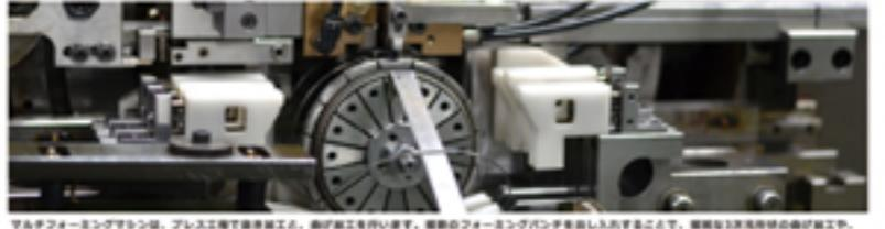
マルチフォーミングマシンは、プレス工場で複数加工と、溶接加工を行います。複数のフォースクランバパンチを組み込むことで、複雑な3次元形状の曲げ加工、溶接加工が行えます。直近登録からのお問い合わせが可能になります。新規品と比べて約40日遅れで、安全な接続の部品を、直近生産しています。
